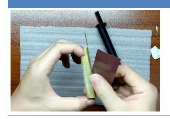
Step 6: 对整齐吃弹杆位置,小心插入铜管,插入前最后打磨一下铜管
